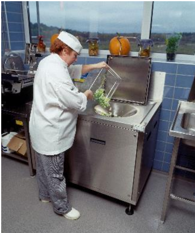
Figur 3. Matavfallsskvarn kopplad till en uppsamlingstank.
