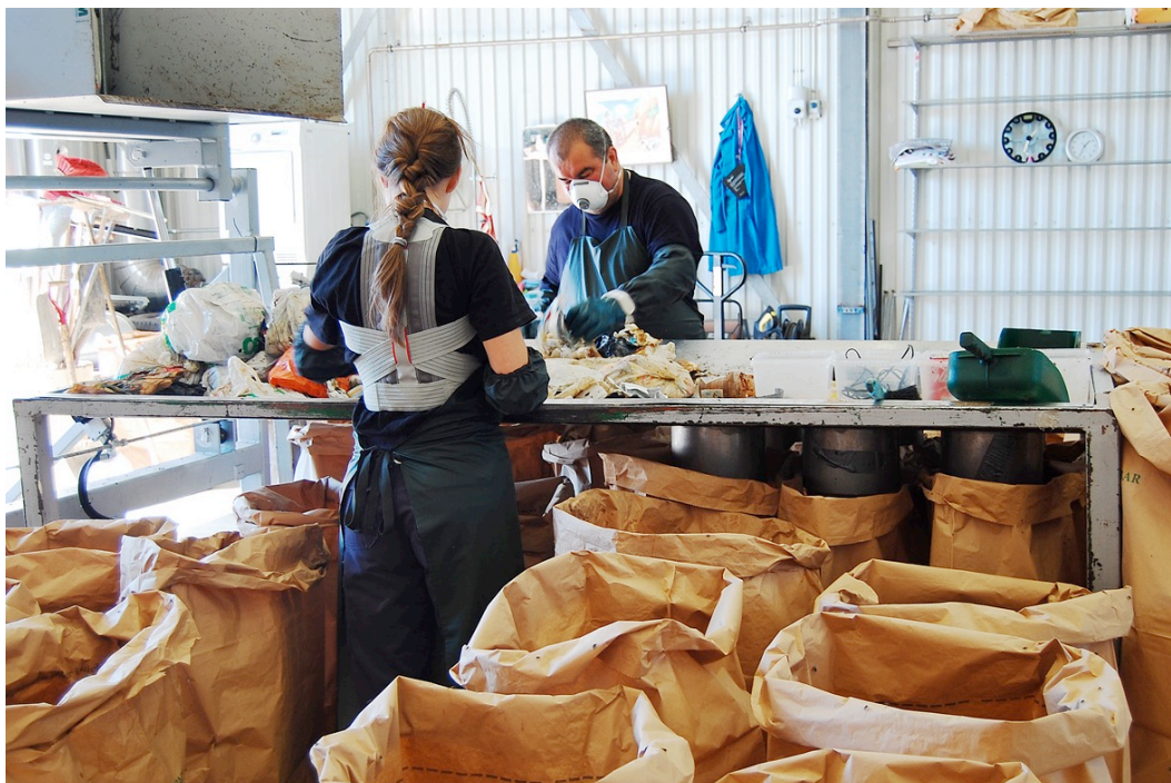
Figur 1. Plockanalys: Avfallet sorteras för hand på avfallslaboratorium i Helsingborg. Källa: Envir Plockanalyser AB, 2016.
